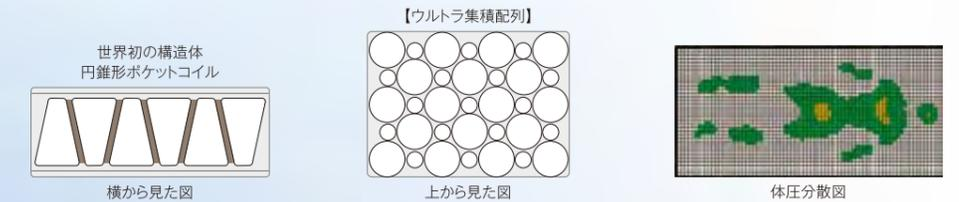
線接触...隣同士のコイルが線接触になるためコイル間の遊びがなくなり横ゆれもなくマットレス全体が硬めに仕上がります。
